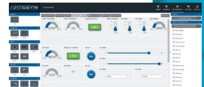
Bild 2: GUI der Überwachungssoftware für die iHP-Serie von Artesyn
