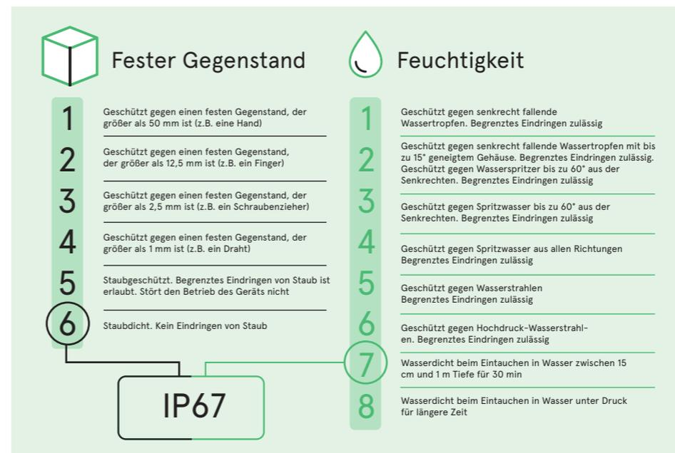
Bild 2: IP-Schutzarten (Ingress Protection)
