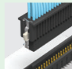
SICHERES EINRASTEN Manuell betätigte Verriegelungen erhöhen die Entriegelungskraft um bis zu 200%
