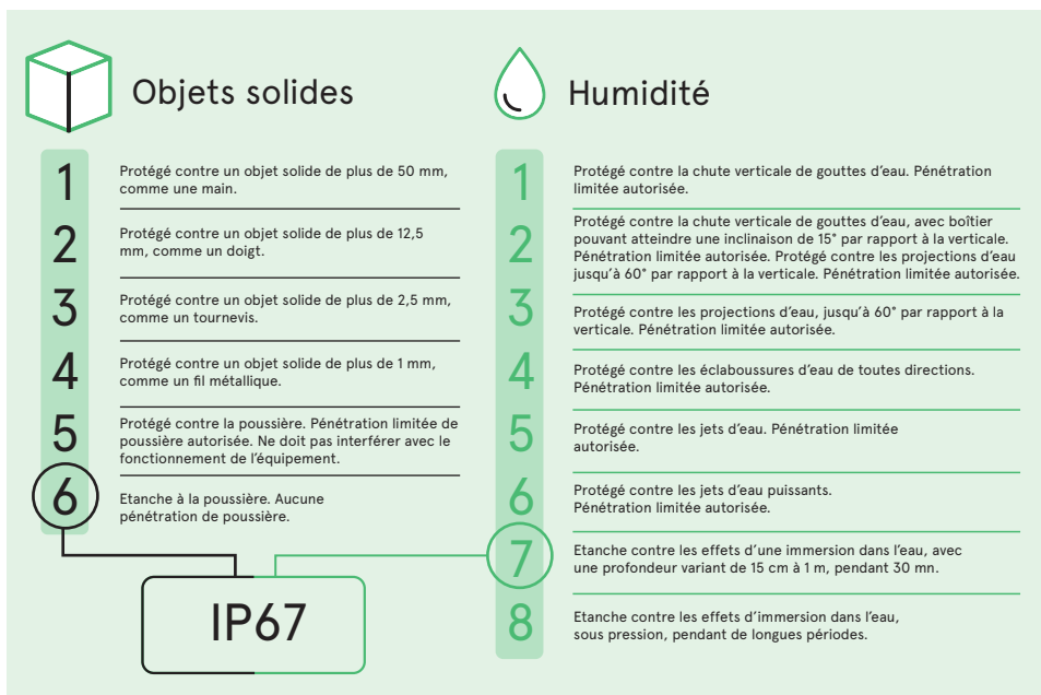
Fig. 2 : Indices IP de protection contre la pénétration
