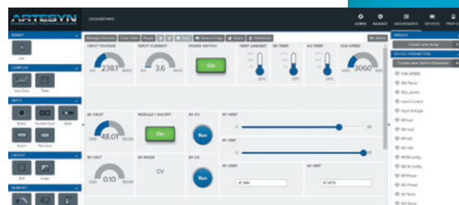
Fig. 2 : Interface graphique du logiciel de contrôle pour la série Artesyn
