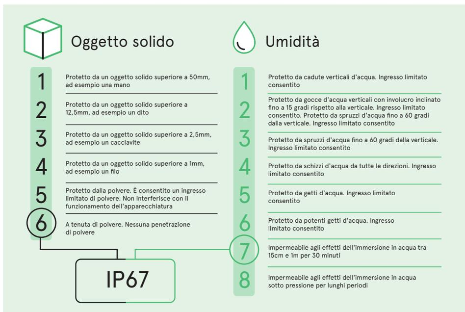
Figura 2: Classi di protezione (IP)
